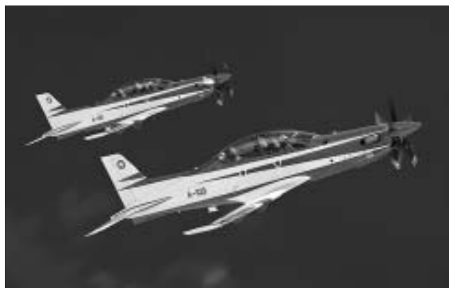
▲瑞士空軍PC-21融合渦槳的大馬力和競速型飛機的流體特性，飛行性能更佳。
