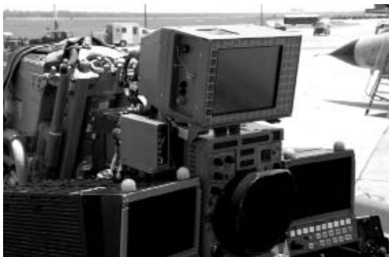
安裝在後座座艙儀表上方的界面電腦單元顯控屏幕(ICU)
