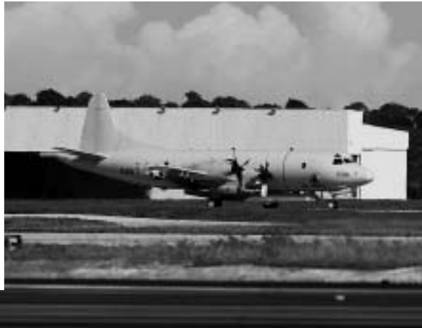
▲中線搭載合成孔徑雷達天線的P-3C III，9月16日
