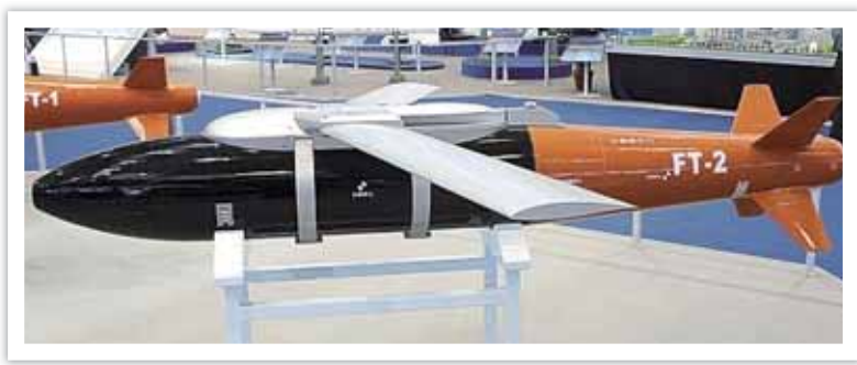
圖七 改良自飛騰-1型之共軍「飛騰-2型」精確導引炸彈(加裝大型彈翼組件)
