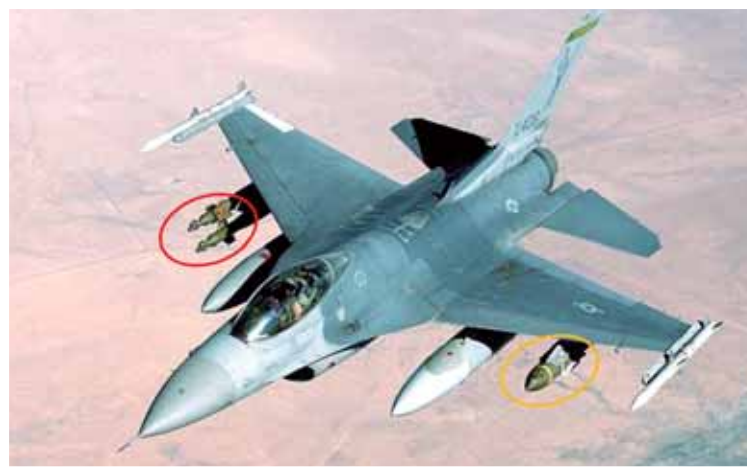
圖一 2004年於伊拉克境內掛載2枚鋪路II型(左機翼下方紅圈處)及1枚JDAM(右機翼下方黃圈處)型精確導引炸彈，執行作戰任務之美軍F-16C戰機。
