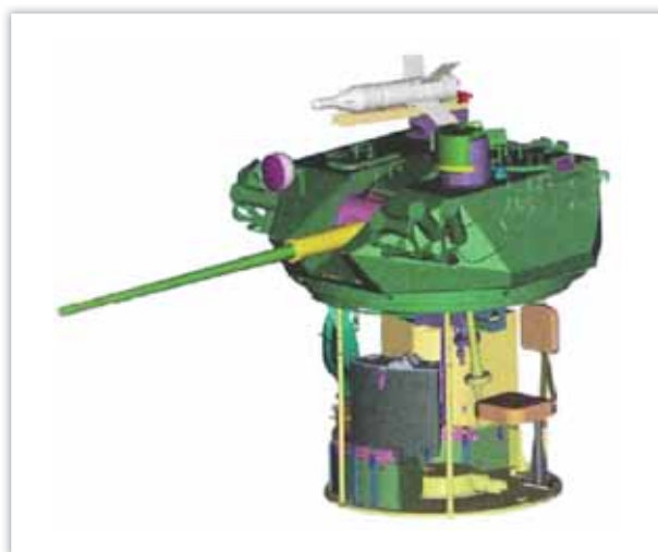
圖十 ZBD 09輪型步兵戰鬥車雙人槍塔示意圖
