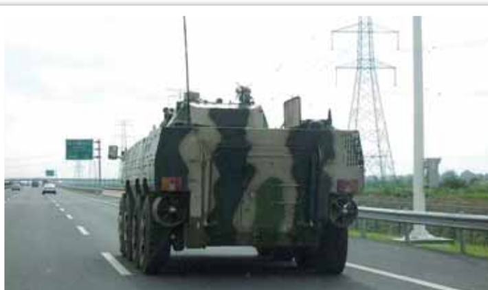
圖八 ZBD 09車體後方配備水上推進裝置
