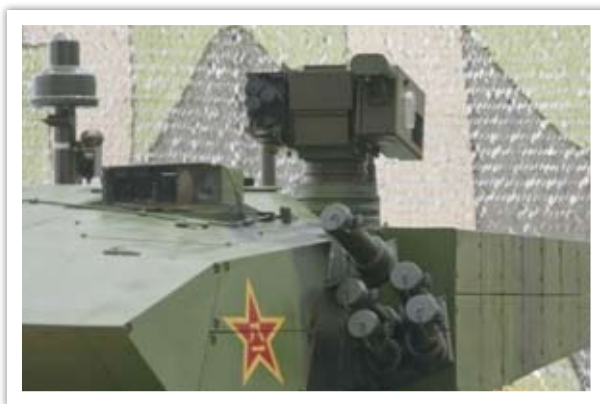
圖十一 中共99式戰車雷射預警系統(右為雷射主動反制裝置，左為雷射通信／預警器共用的接收器)
