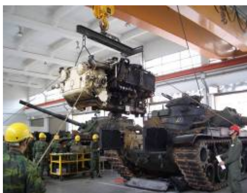
圖 4 引擎回裝測試
