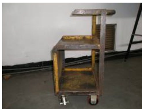
圖 9 初步焊接完成的車台
