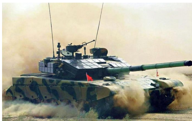
中共 99A2 使用 1500 匹渦輪增壓中冷式柴油引擎
