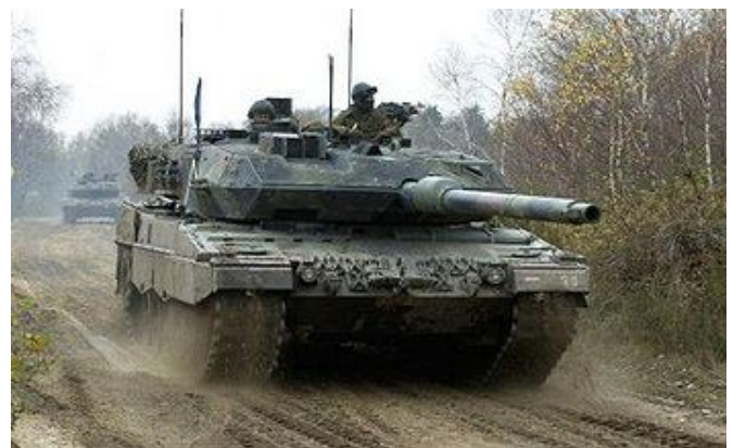
豹 2 使用 MTU MB 873 型 1,500 匹馬力柴油發動機
