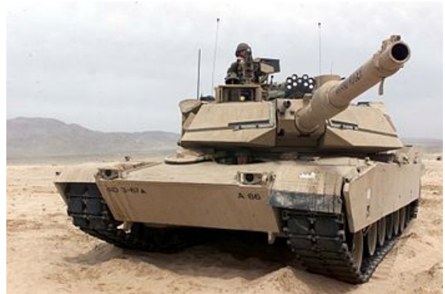
M1 戰車使用 AGT-1500 燃氣輪機作為發動機
