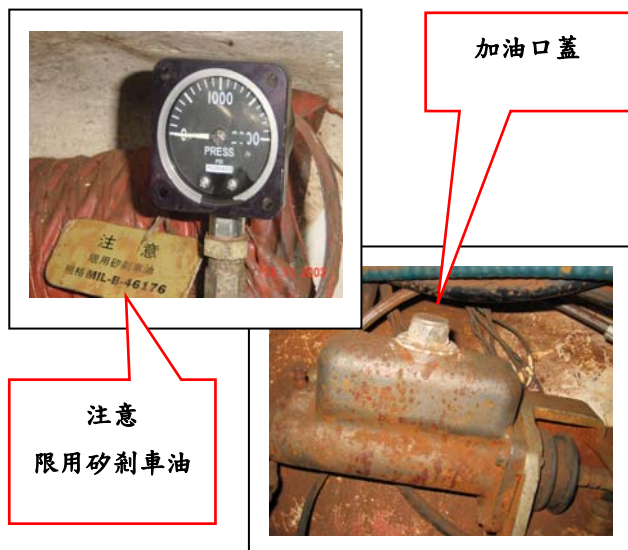
圖二 剎車總泵、剎車壓力表及警告牌
