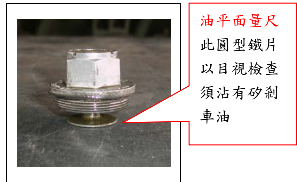
圖三 剎車總泵加油孔蓋油平面量尺
