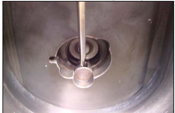
圖 21：拉出發火機與後退導桿
