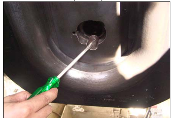
圖 30：將後退導桿向前推至定位
