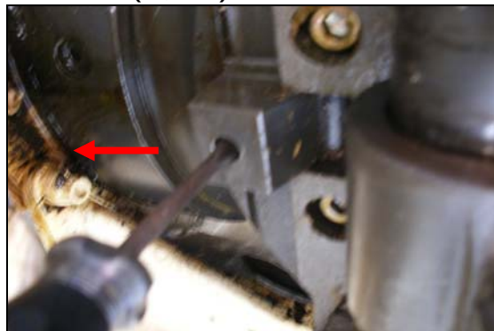
圖 26：推砲門阻鐵向砲口方向
