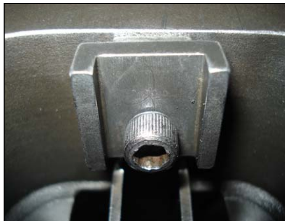
圖 13：砲門夾箍安裝不正確
