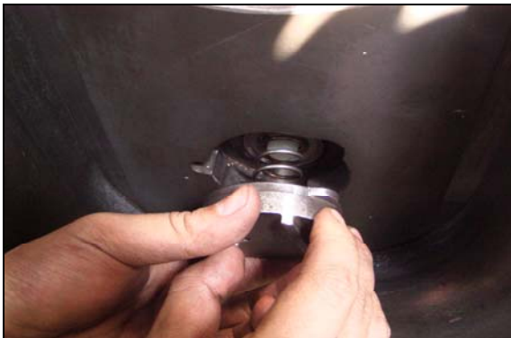
圖 33：左手放開擊針簧移於火門蓋後端
