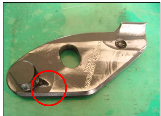
圖 11：退殼片頂塞損壞
