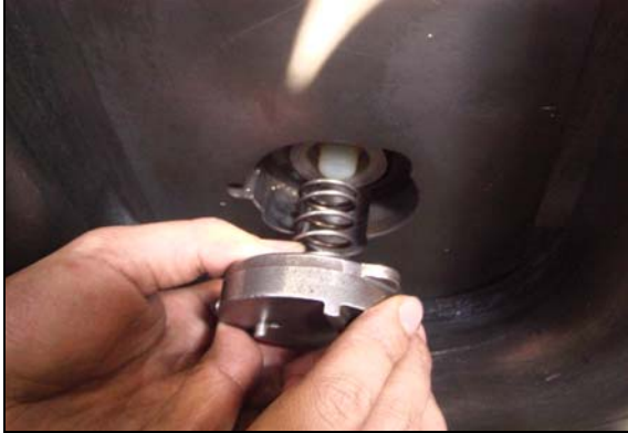
圖 32：將擊針簧置於發火機後端
