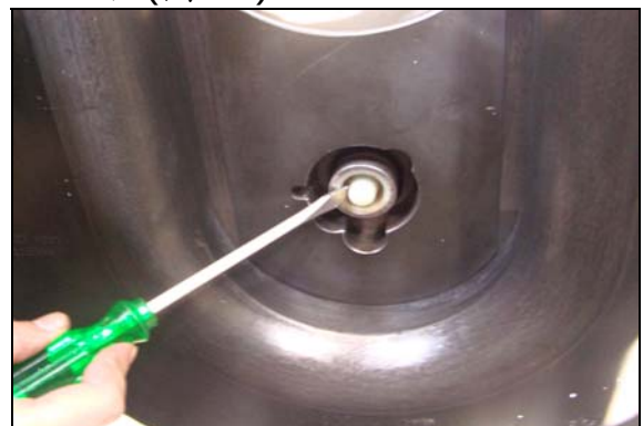
圖 31：將發火機向前推至定位
