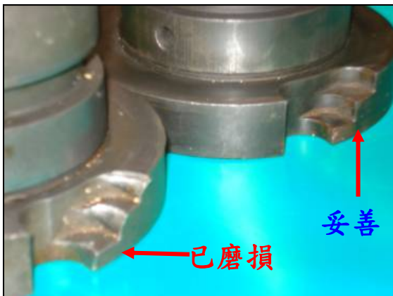
圖 10：關門簧調節器螺旋壓縮座磨損
