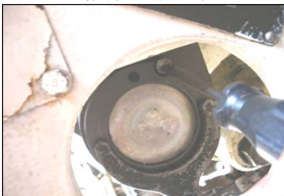
圖 25：六吋長平口起子壓下關門簧頂塞
