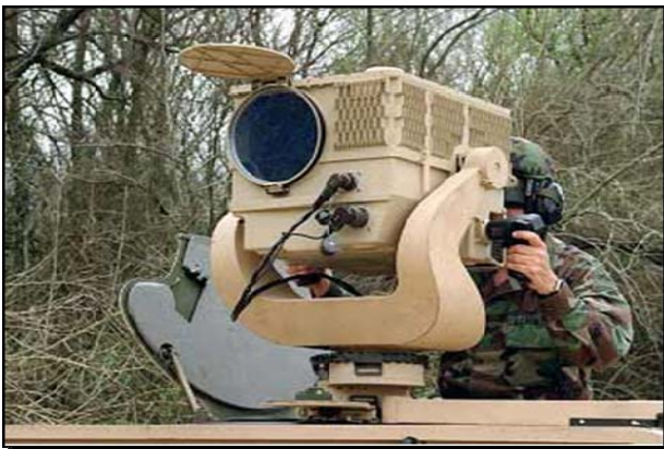
圖 16 美軍長距離情偵監系統 AN/TAS-8 Long Range Advanced Scout Surveillance Sensor (LRAS3)，圖片來源受訓資料
