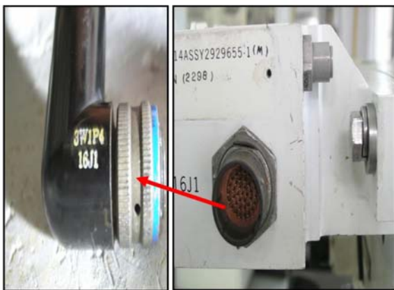
圖 7 拆下 J1 接頭上之電纜 3W1P4 (資料來源：筆者整理)
