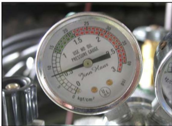
圖 12 低壓力錶指示在 8psig
