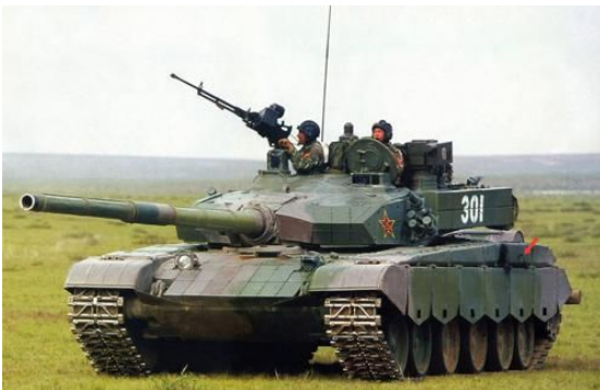
【圖 15】砲塔前端加裝了外形類似德國豹 2A5 戰車上的楔形附加裝甲模塊，因此增強了正面防護能力。
