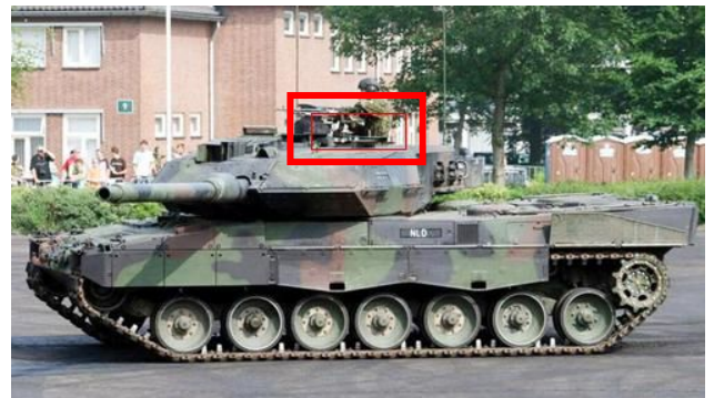
【圖 13】豹 2A6 戰車裝填手機槍安裝在環形槍架上，射界十分開闊。
