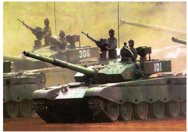
【圖 6】正前方為駕駛員(主砲下方)，左側為射手，右側為車長(操縱機槍者)
