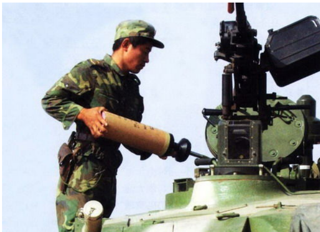
【圖 10】乘員正在傳送尾翼穩定脫殼穿甲彈至砲塔
