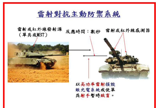
【圖 9】JD-3 型雷射主動防禦系統示意 圖片來源：取自裝甲兵學術月刊 209 期 主動防禦系統簡介第 18 頁 ，作者鄭順彰老師。
