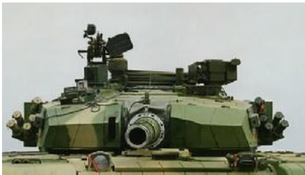
【圖 8】砲塔上可以清晰的看到主要瞄準裝置；左側頂部機槍下方為車長瞄準裝置系統，車長機槍後方
