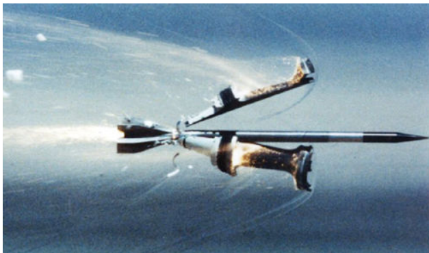
【圖 11】翼穩脫殼穿甲彈出砲口後，脫殼片脫落的情景，圖為高速照相機所拍攝。
