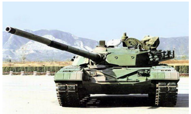
【圖 7】99 式戰車採用焊接結構的楔形砲塔
