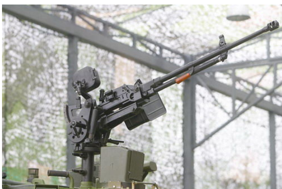
【圖 12】99 式戰車的 12.7mm 機槍，安裝在一個固定槍架上，不便於 360 度全向射擊。
