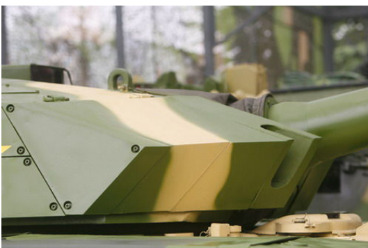
【圖 15】砲塔前端加裝了外形類似德國豹 2A5 戰車上的楔形附加裝甲模塊，因此增強了正面防護能力。
