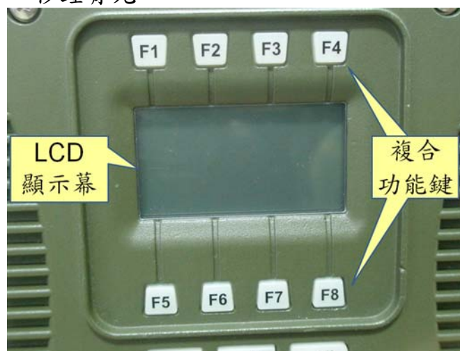
圖十九：駕駛/車長控制盒(ACU)複合功能按鍵及顯示幕
