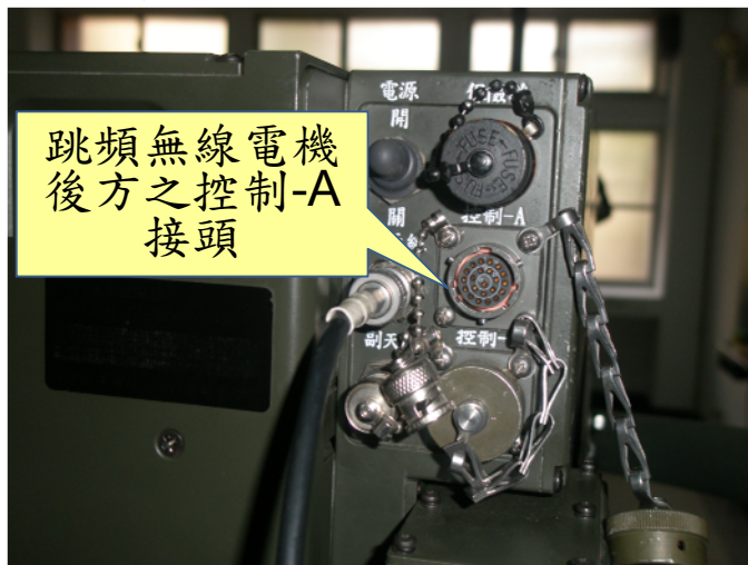
圖五十五：跳頻無線電機與VIC-1界接 接頭 資料來源：作者自行拍攝
