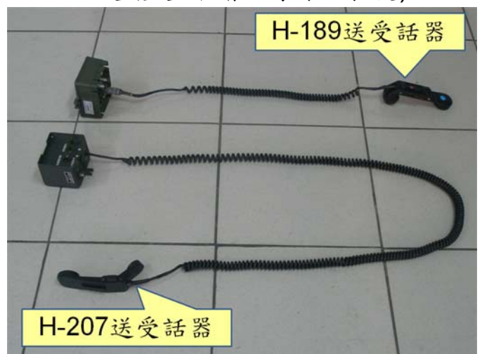
圖五十三：新舊系統車尾接線盒話筒長度比較圖
