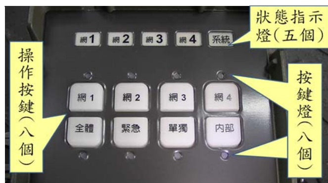
圖二十二：基本型乘員控制盒(BCU)操作按鍵及狀態指示燈
