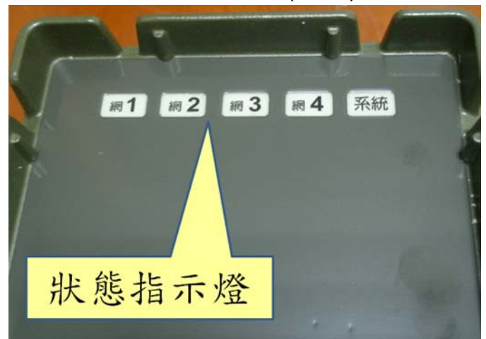
圖二十四：無線電界面控制盒(EPU) 狀態指示燈 資料來源：作者自行拍攝
