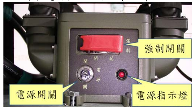
圖三十二：車輛電源突波吸收器面板 資料來源：作者自行拍攝
