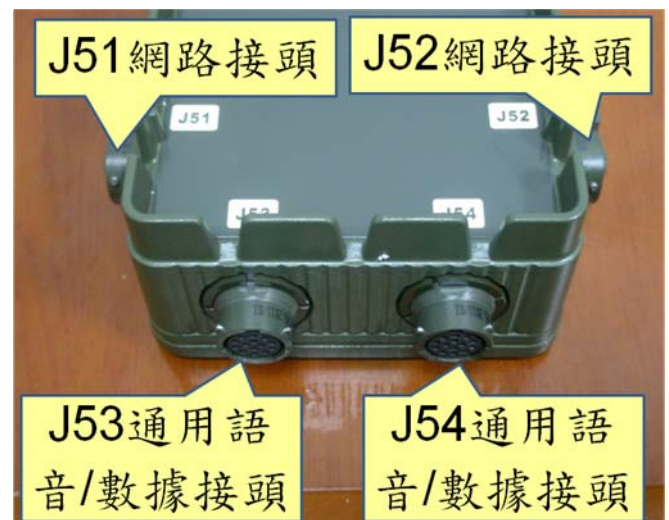
圖二十五：無線電界面控制盒(EPU)接頭 資料來源：作者自行拍攝
