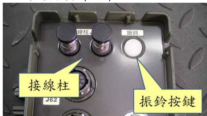
圖二十六：車尾接線盒(EFT)震鈴按鍵及接線柱
