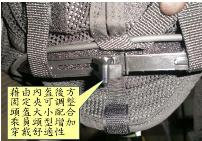
圖十五：內盔調整固定夾 資料來源：作者自行拍攝
