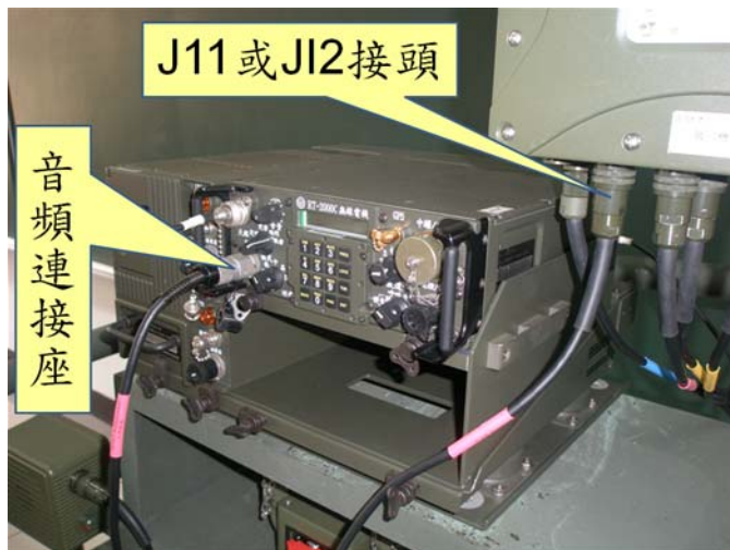
圖五十四：HITS-2000IP與跳頻機界接 資料來源：作者自行拍攝
