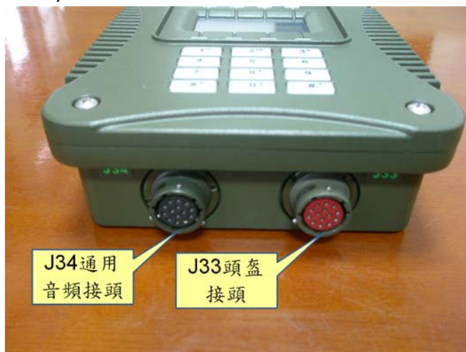
圖二十：駕駛/車長控制盒(ACU)音頻接頭及頭盔接頭
