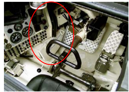
豹2 戰車內部 NBC 系統安裝位置 資料來源： http://www.nmgjy.com/tank/ 置，其進氣口設於車體右側，乘員需透過通氣管與面具從中央過濾機獲得乾淨空氣。
