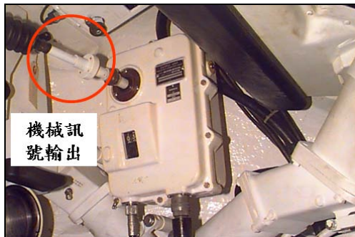
圖五十八:戰車輸出裝置將超仰角資料經機械連桿傳動至彈道驅動器(作者自攝)
