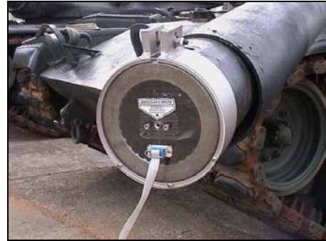
圖三十:主砲雷射發射器架設於60戰車砲口端(作者自攝)
