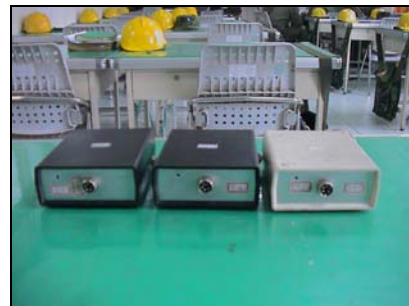
圖三：主砲、同軸及車長機槍雷射發射器電源盒(作者拍攝)
