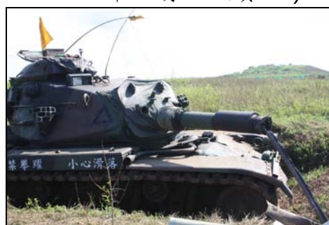
圖五十二:戰車砲管炸裂(作者拍攝) (四)射擊訓練方式須能兼顧訓練
