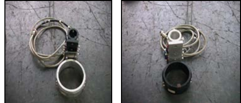
圖二：同軸及車長機槍雷射發射(作者拍攝)
