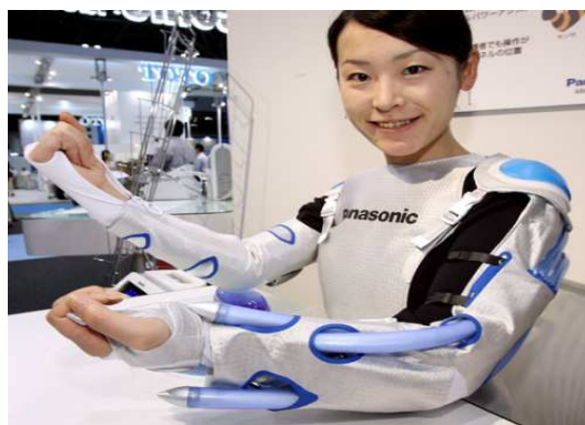
圖十：日本公司推出的充氣式外骨骼手臂
