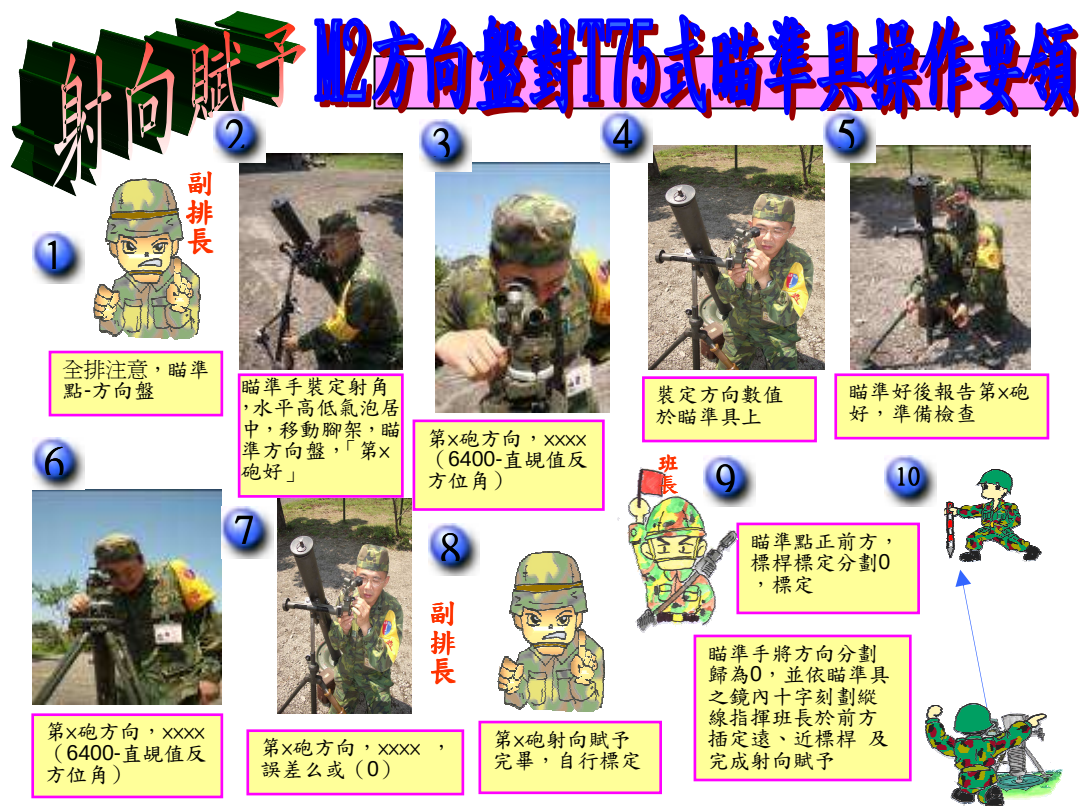
圖 9-2 M2 方向盤對 T75 式瞄準具射向賦予操作要領組圖
