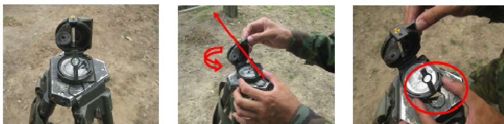
指北針平置於 M2 方向盤腳架平面
