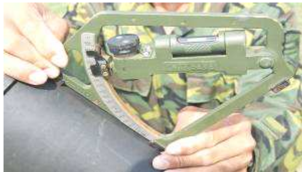
圖 11 象限儀置於砲身軸線上實施角度校正
