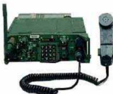
圖一 SINCGARS(單頻地空無線電機)
