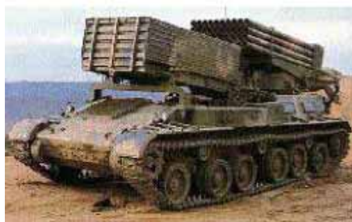
圖四 中共122公厘多管火箭系統，仿製前蘇聯BM-21型122公厘多管火箭系統，改良後已大幅提升發射速度
