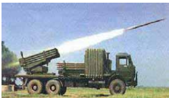
圖四 中共122公厘多管火箭系統，仿製前蘇聯BM-21型122公厘多管火箭系統，改良後已大幅提升發射速度
