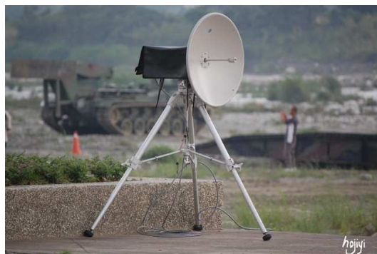
圖十九 中繼碟型天線接收 CCD 影像
