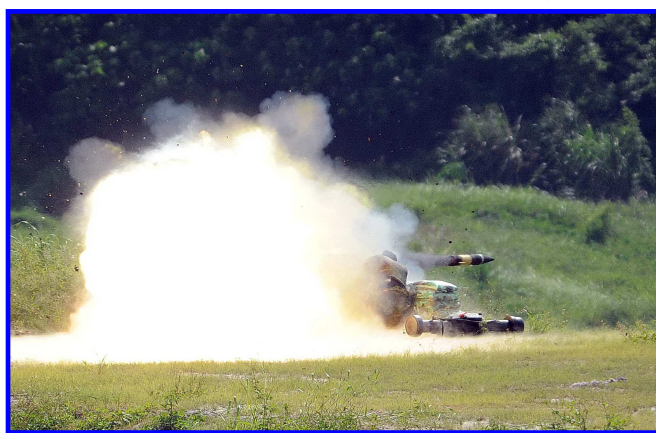
圖三:APILAS 火箭彈射擊產生之筒後噴火
