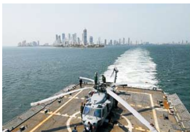
圖六 寬大的飛行甲板，適合操作CH-53或是CV-22等中大型直升機
