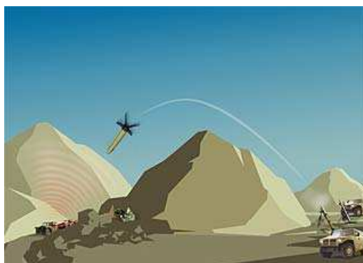
圖 3：精準彈藥利用尋標及終端導引功能、精準鎖定攻擊目標圖 14
