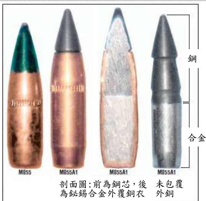
圖 4：M855A1 初型彈藥圖說
