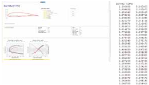
圖2 翼剖面SD7062之各數值點座標資料。 。
