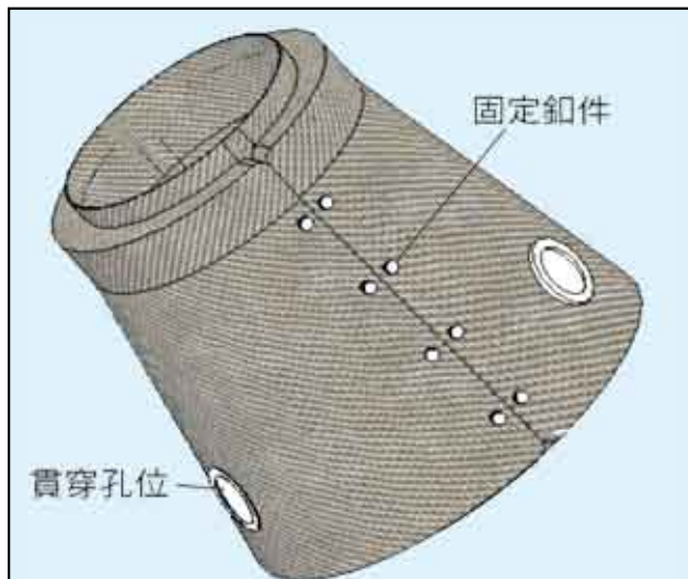
圖四 兩件式圓錐型隔熱罩組合示意圖
