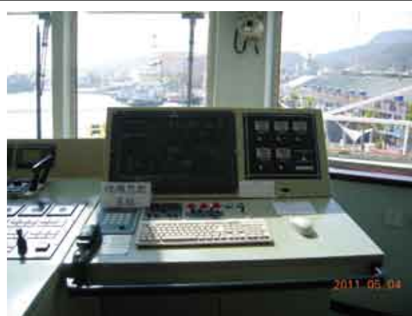
圖九 東海救113號現代化遠洋多功能救難船『全船暨救難專用之視頻監控系統』
