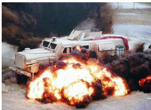
圖八：MRAP 進行地雷試炸試驗
