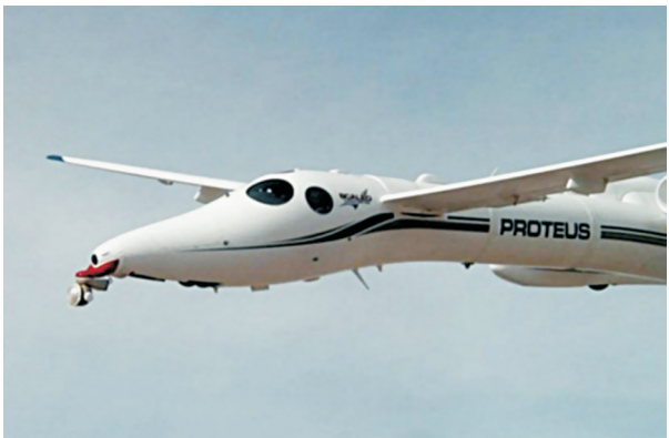
圖八 美國海軍於一架飛行平台上測試A1-130 OASys避撞雷達
