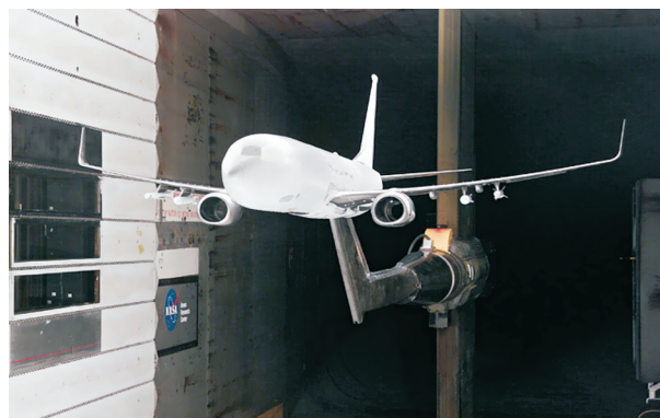
圖四 在波音低速風洞吹試的十六分之一小尺寸P-8A模型
