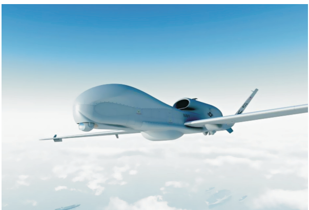
圖七 RQ-4N「廣域海上監視」無人空中系統，機鼻下為光電/紅外感測器旋轉裝置，機腹下為主動掃描陣列搜索雷達
