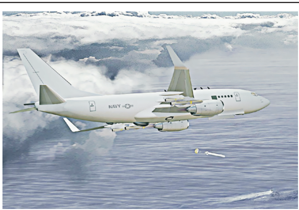
圖六 由B-737客機研改的P-8A，翼尖小翼後掠，後機身改為武器艙，機翼下方還可掛載多種武器
