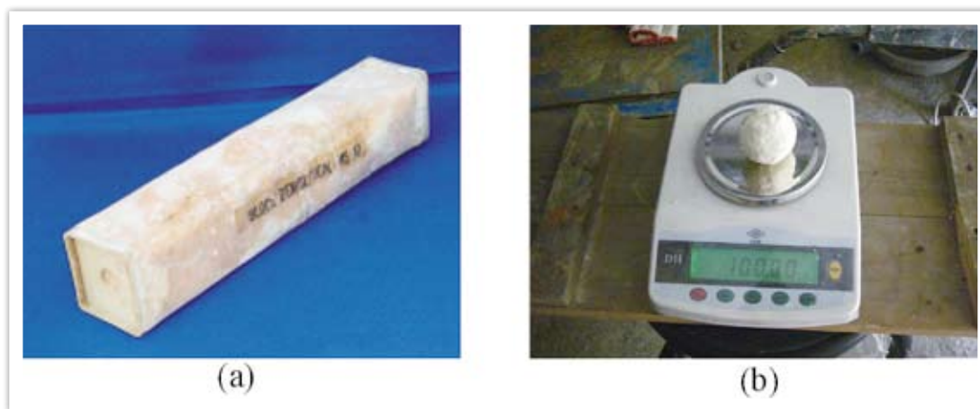
圖十 C-4炸藥 (a) 原M5A1藥包 (b) 拆解揉成100g球型炸藥
