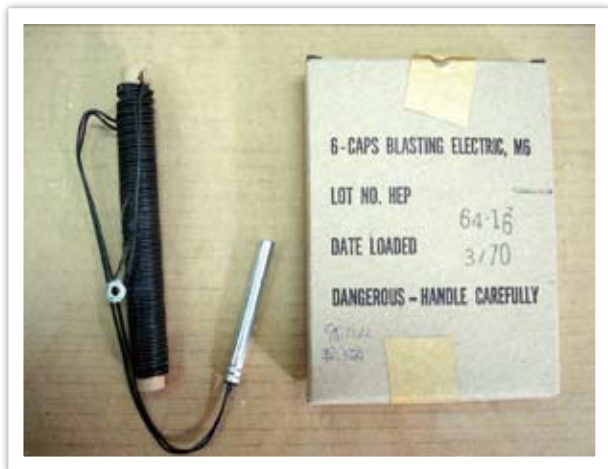
圖十一 美造J2測試電雷管
