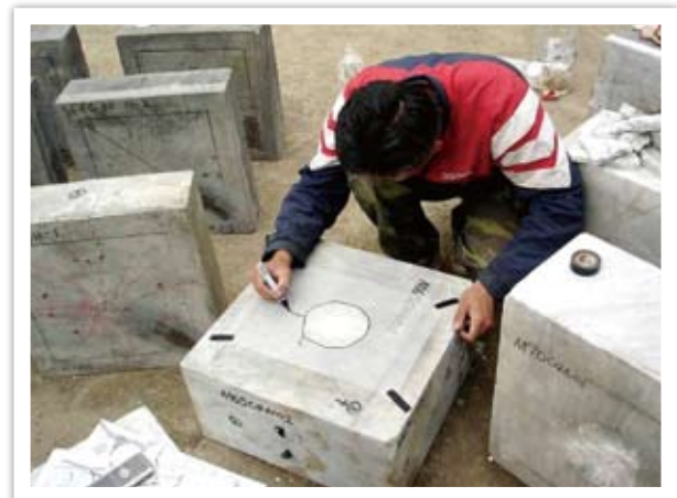
圖十六 使用描圖紙描繪坑洞形狀
