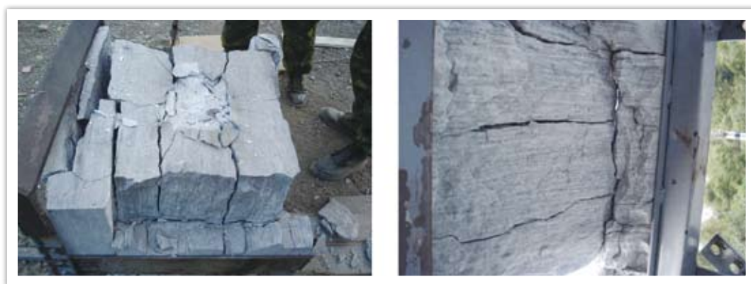
圖廿 150gC-4炸藥接觸爆炸下大理岩試體破裂情形
