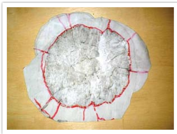
圖十七 使用砂膠對正面成坑進行翻模
