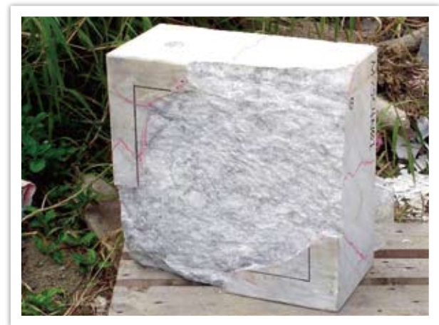
圖廿三 75gC-4炸藥接觸爆炸下大理岩試體背面大片剝落情形
