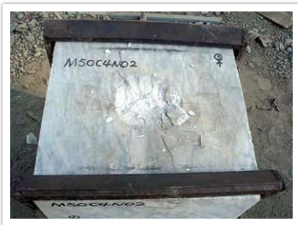
圖廿二 50gC-4炸藥接觸爆炸下大理岩試體破裂情形
