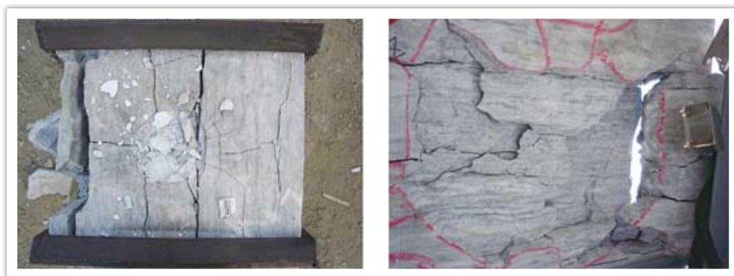
圖廿一 100gC-4炸藥接觸爆炸下大理岩試體破裂情形
