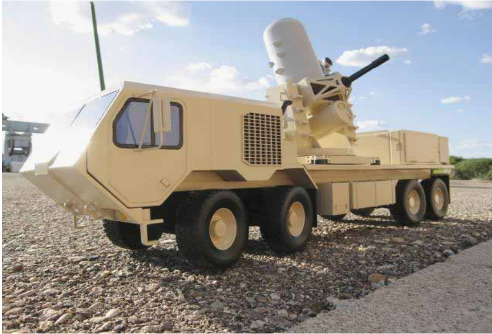
圖二、美製「百夫長」(Centurion)機動式陸基方陣武器系統 資料來源：Jane's Land-Based Air Defence (Raytheon)， http://10.22.155.6:80 ，07-Jun-2010。
