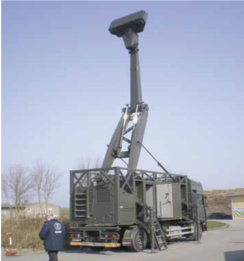
圖一、紳寶(Saab)微波系統公司研製成功之「長頸鹿砲兵火力雷達」(Giraffe Fires Radar，GFR)系統
