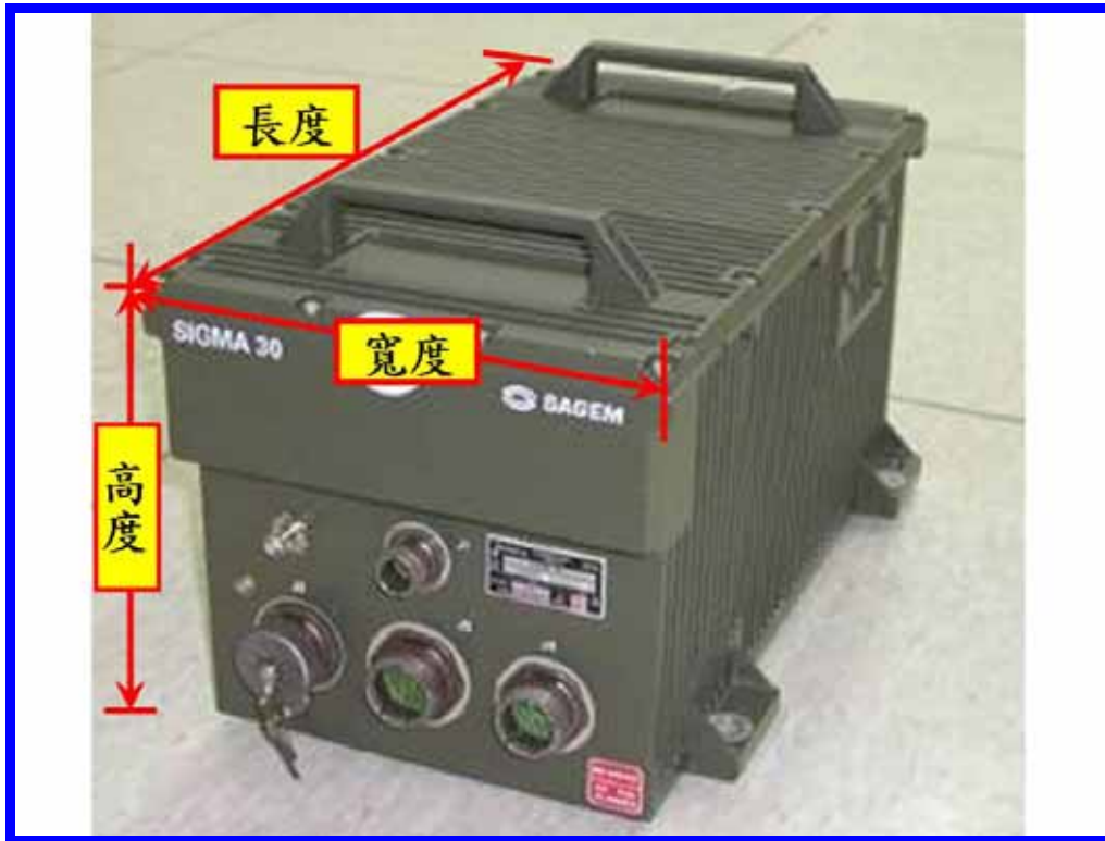
本軍新式雷霆 2000 火箭砲車 SIGMA-30 定位定向系統：長：41 公分，寬 21 公分，高：22 公分。（圖片來源：同註 13）
