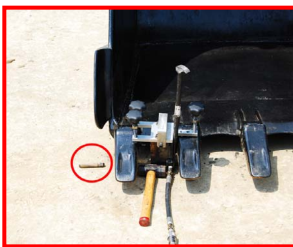
圖廿一 拆卸完成 資料來源：作者拍攝
