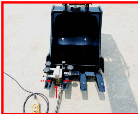
圖卅八 已做調整及切削，使其能拆卸 304C 型挖土機
