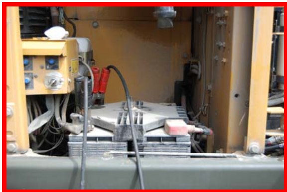
圖十六 電源連接線與電瓶連接 資料來源：作者拍攝
