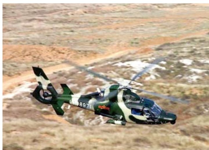
圖七 直-9型直升機採用普通旋翼加涵道風扇尾槳配置方式
