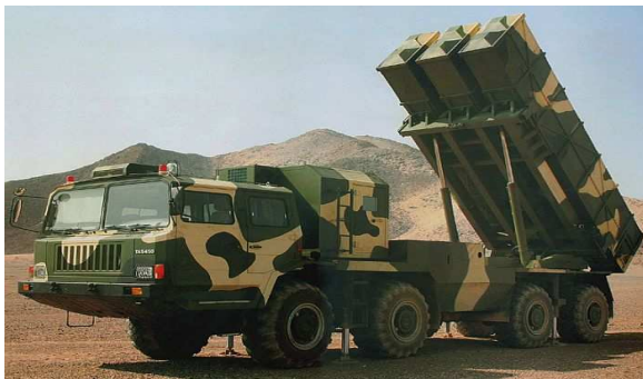
圖六 衛士-2D 型多管火箭發射車，採用新的方形模組化發射箱
