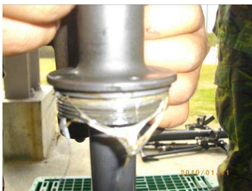
圖 4：以止水帶維修砲架
