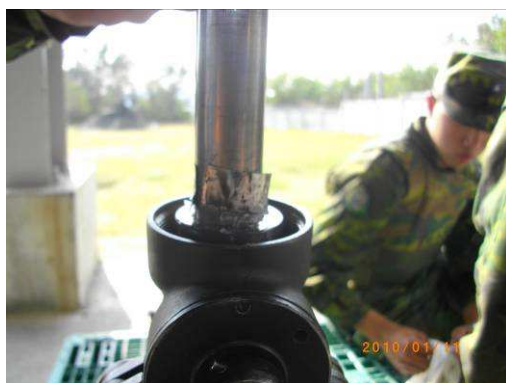
圖 3：以止水帶維修砲架
