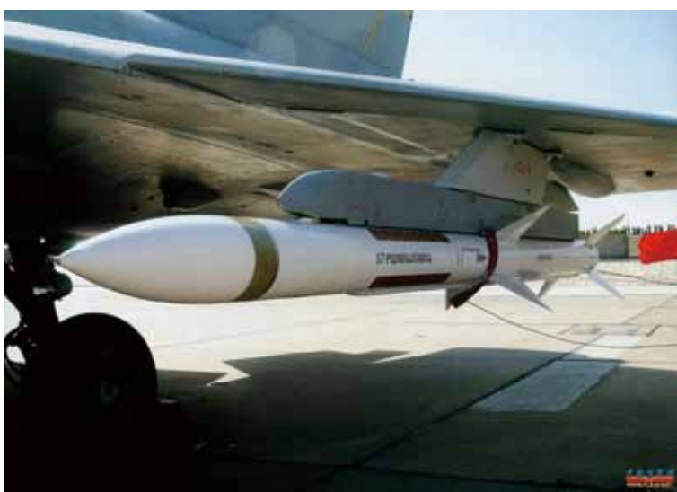
《圖5》以義大利Aspid飛彈為範本的PL-12 (SD-10) BVR中程飛彈射程達100公里。
