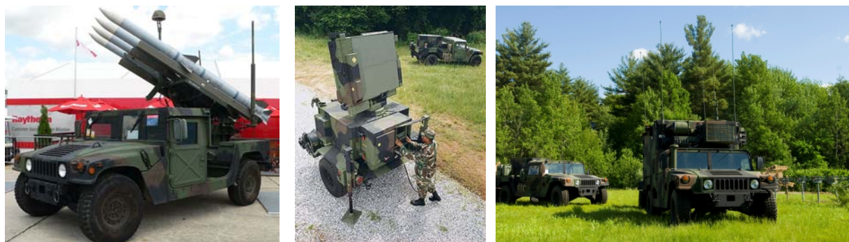
圖十八 Surface-Launched SL-AMRAAM 先進中程地對空防空飛彈系統 (左) 陸射 AIM-120 飛彈 (中) MPQ64 哨兵機動雷達 (右) FAAD C 2 指管系統
