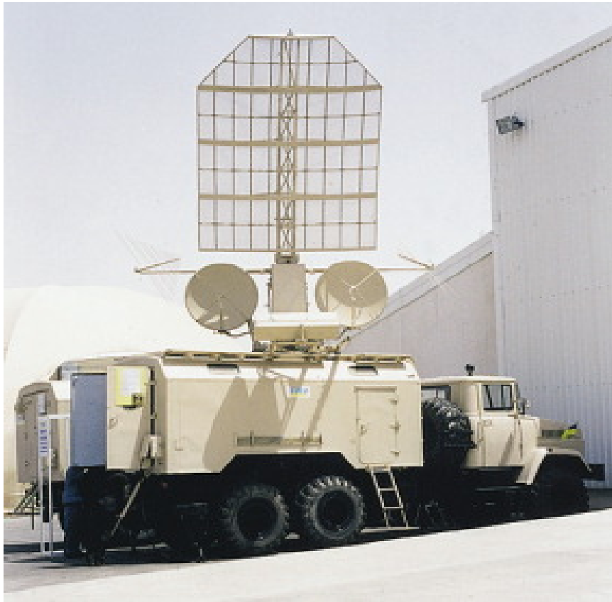
圖三、Kolchuga 被動雷達系統偵測站及接收天線
