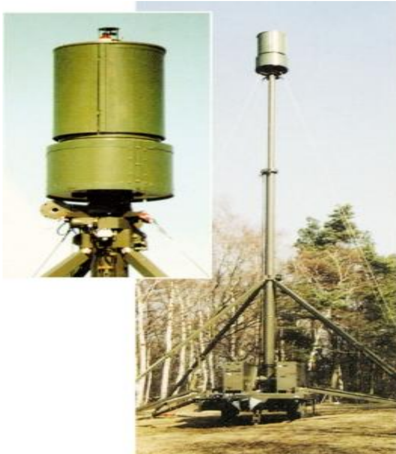
圖二、捷克陸軍 VERA-E 被動監視雷達系統
