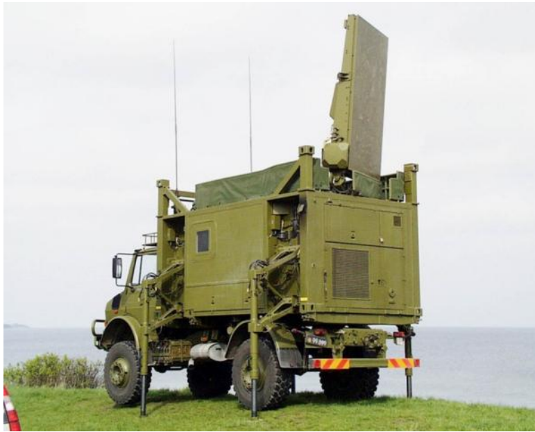
圖五：丹麥陸軍將 ARTHUR—A 雷達安裝於 Unimog 2150L 4×4 載重車
