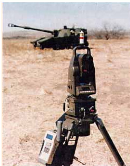
圖十：美軍砲兵連（排）編配之「火砲射向賦予與定位系統」(GLPS)
