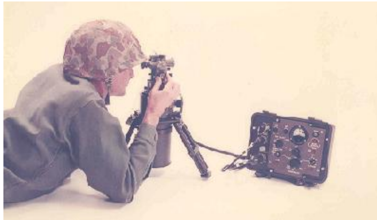
圖九：美軍砲兵測地使用之「輕型方位陀螺儀」(SIGAL)
