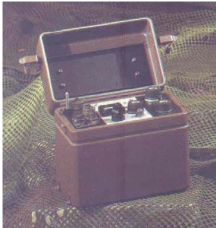
圖五：Wild GG1 陀螺經緯儀之「小型陀螺電子裝置」(SKE1)
