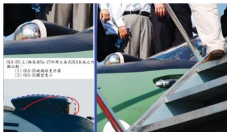
fig.27 OLS-35 玻璃罩外露部分超過半個球面，這是與舊型號(藍色虛線)很大的差異(作者攝)
