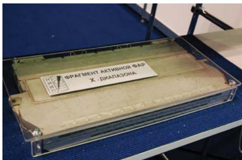
fig.15 NIIP的主動X波段相位陣列雷達天線單元 (作者攝)
