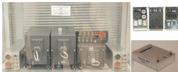
fig.28 SUO-35P 武器控制系統(部分)，電路版，以及 TKN 固態繼電器(作者攝)
