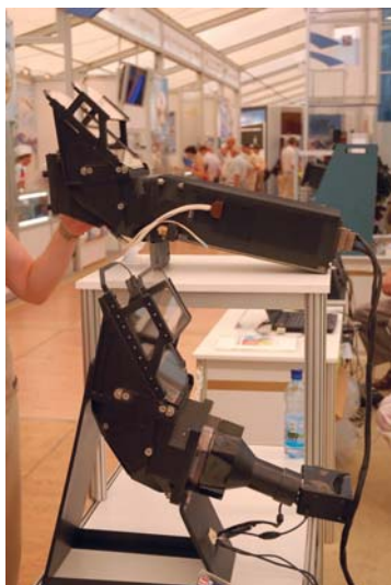
fig.13 採固態圖形產生器之抬頭顯示器與傳統者之大小對比(作者攝)
