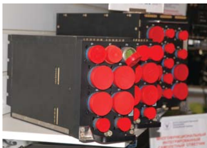
fig.3 Solo-01 信號處理電腦與 Solo-02 資料處理電腦 (作者攝)
