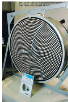
fig.22 左 N-012 採用類似的非等距圓形天線佈局，圖為 NIIR 的 Zhuk-MSFE 雷達(作者攝)
