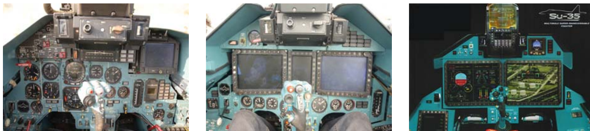
(fig.6,7,8 左至右) 4, 4+, 4++代 Su-27 家族座艙比對：由左至右依序為 Su-33(作者攝)，Su-27SM(作者攝)，Su-35BM(取自 Sukhoi 型錄)座艙，注意其操縱桿“歪一邊”的安置法；HUD 兩旁為頭盔瞄準具定位裝置。
