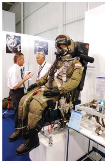
fig.14 K-36D-5 彈射椅，後方右側為總設計師(作者攝)
