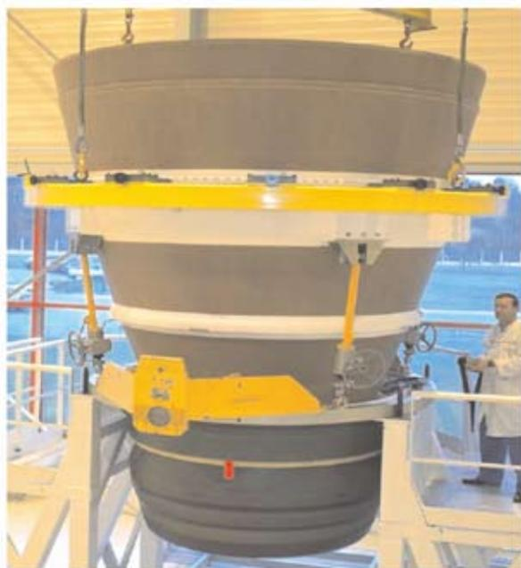
圖七 法國亞利安運載火箭發動機大型碳／碳噴嘴模組。
