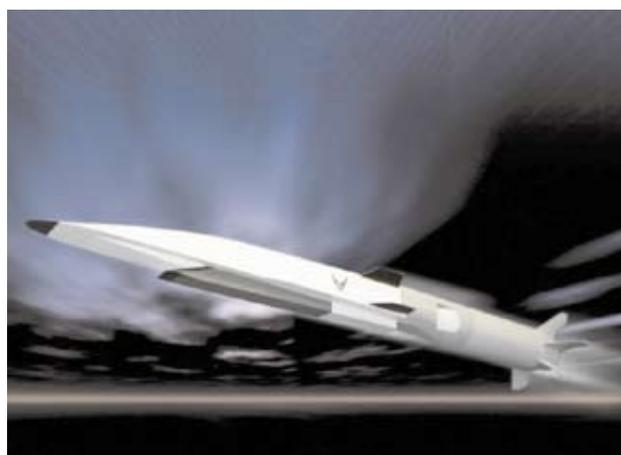
圖四 美國X-51A超燃試驗載具於2010年5月飛試，速度約5馬赫、持續推進約140秒
