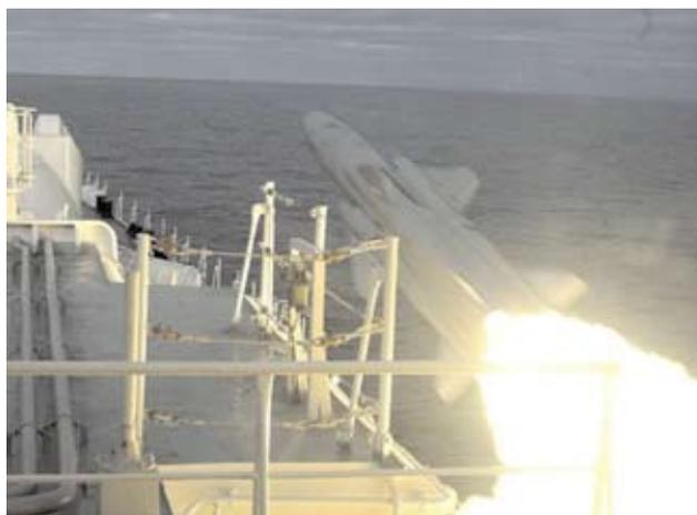
圖三 日炙超音速反艦飛彈由中共現代級驅逐艦發射
