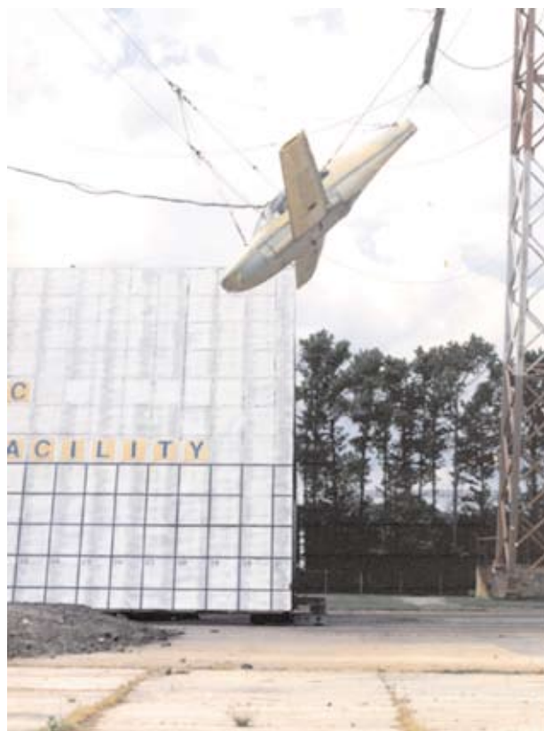
圖二 NASA IDRF固定翼小飛機衝擊實驗[9]
