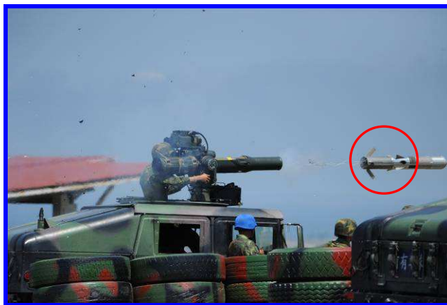
圖三 控制翼自動展開
