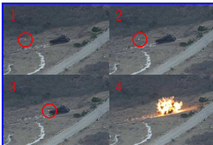
圖五 彈尾紅外線訊號連續圖
