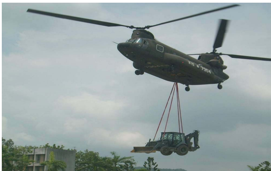
圖二十八 直升機吊掛作業
