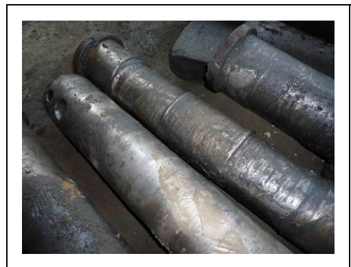
圖 4 斗鏟軸承磨損情形 資料來源：作者拍攝。
