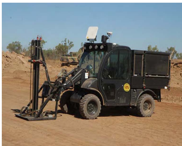
圖 16：為 RAVEN 快速評估工程車進行自動化動態錐貫入試驗（DCP）實景
